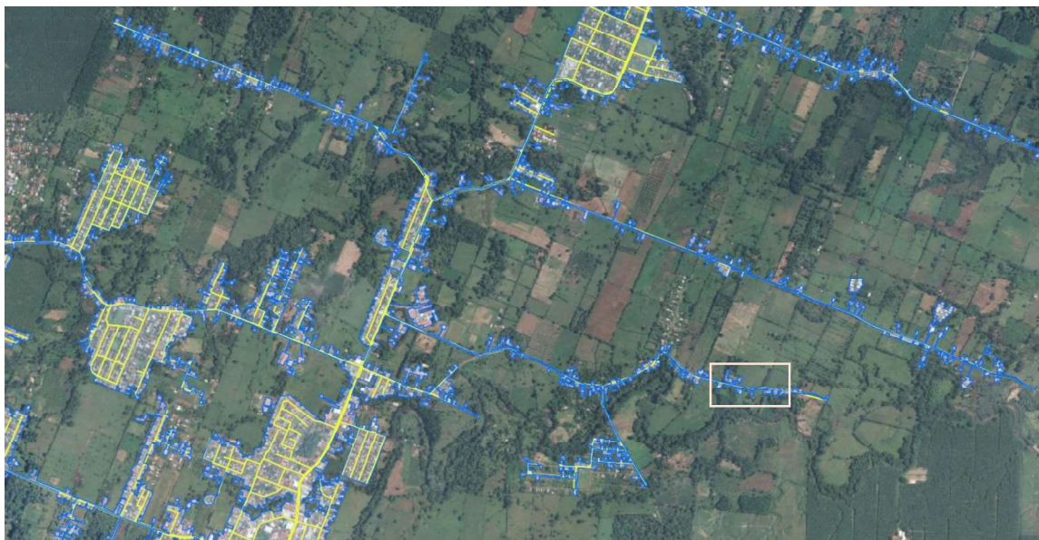
Figura 3: Área parcial de influencia ajustada mediante fotografía aérea a partir de las líneas de distribución del acueducto de Cariari-Anita Grande.
