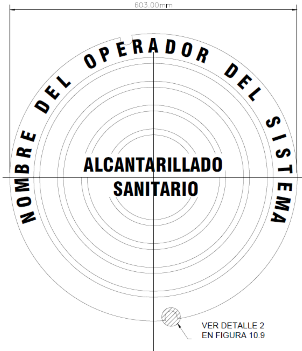
TAPA PARA POZO DE REGISTRO ESCALA 1:5000
