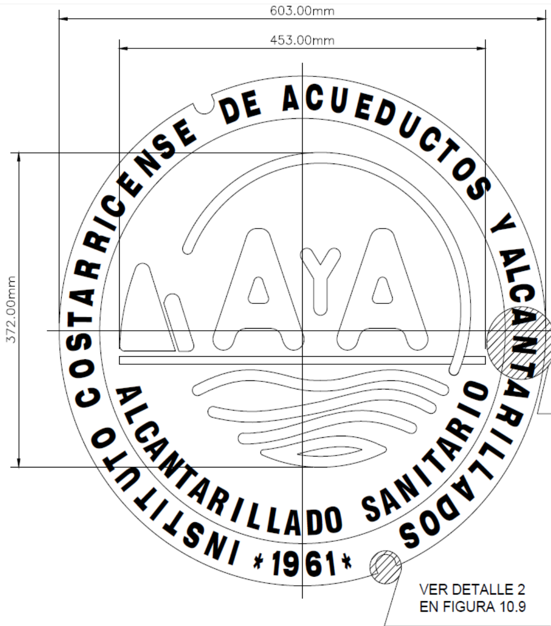
TAPA PARA POZO DE REGISTRO SANITARIO ESCALA 1:5000
