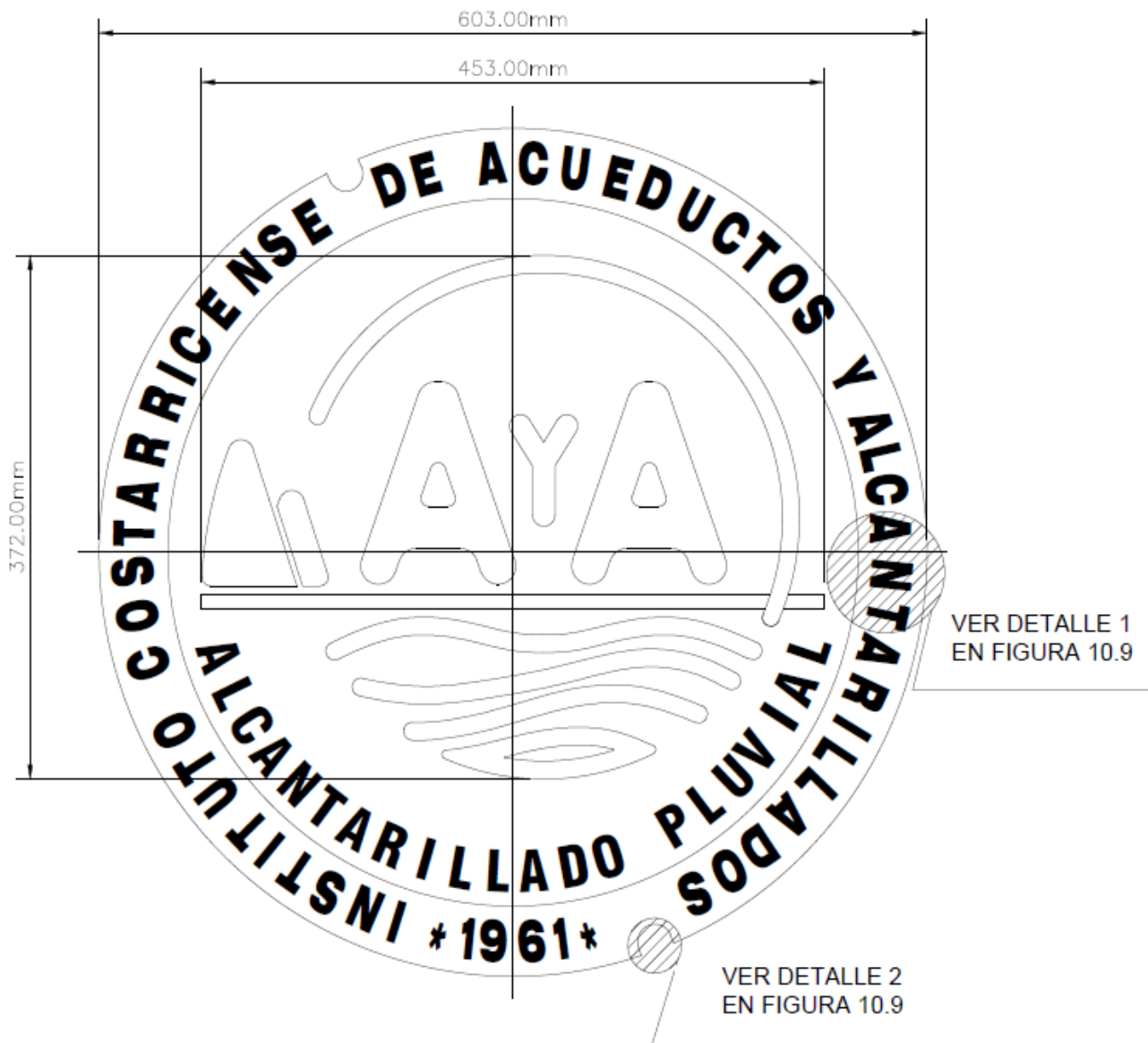
TAPA PARA POZO DE REGISTRO PLUVIAL ESCALA 1:5000
