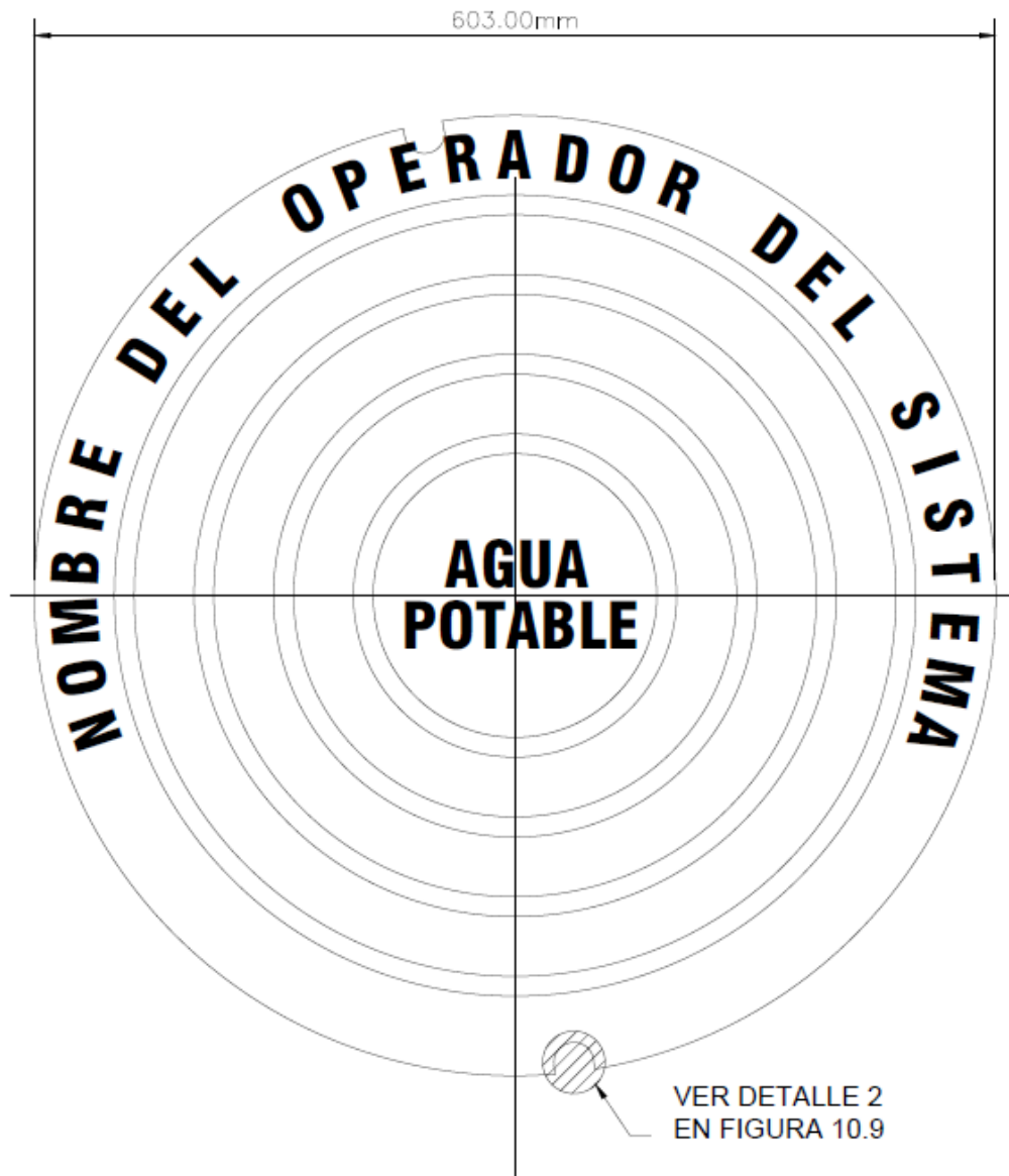
TAPA PARA POZO DE REGISTRO ESCALA 1:5000
