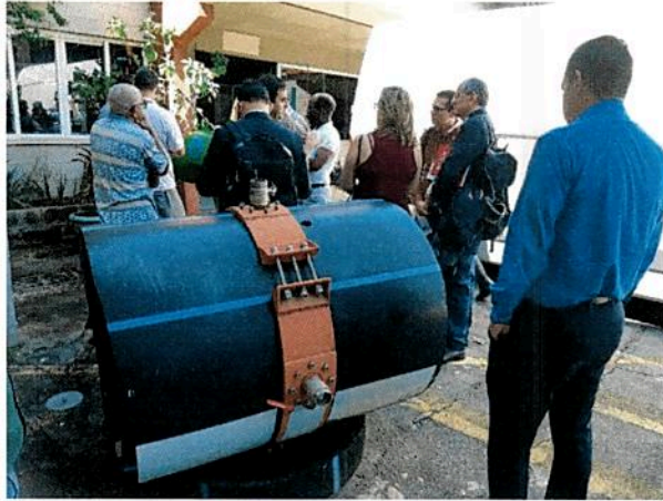
Fig No 4: Segmento de Tubo de Polietileno mostrando mecanismo de medición de presiones en el laboratorio de materiales.
