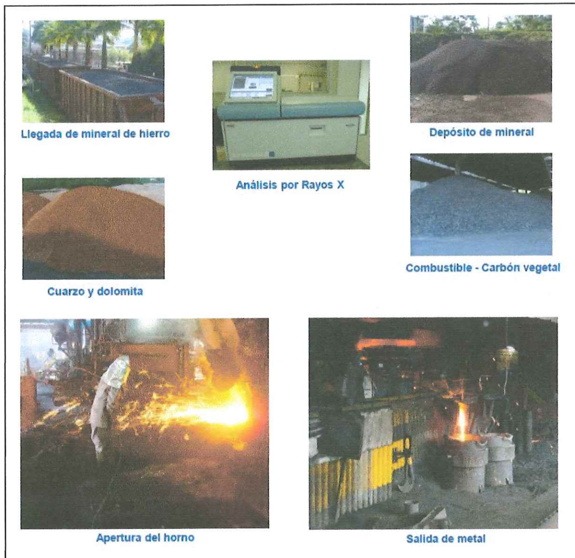
Figura 8. Proceso de fundición para producción de tuberías de hierro dúctil. Fuente: Material suministrado en la Academia PAM Latinoamérica 2017.
