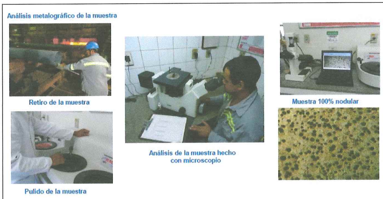
Figura 10. Procedimiento para ensayo de metalografía. Fuente: Material suministrado en la Academia PAM Latinoamérica 2017.
