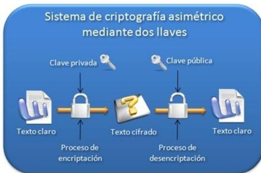
Figura 1: Sistema de criptografía asimétrica mediante la utilización de un par de llaves.
