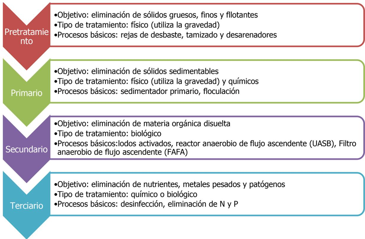
**Figura 1:** Partes del tratamiento de aguas residuales
