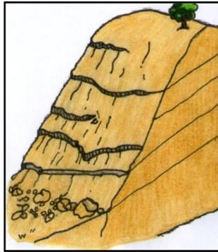
Figura 25: Deslizamiento por caída de materiales. (Fuente: GTZ, 2007)
