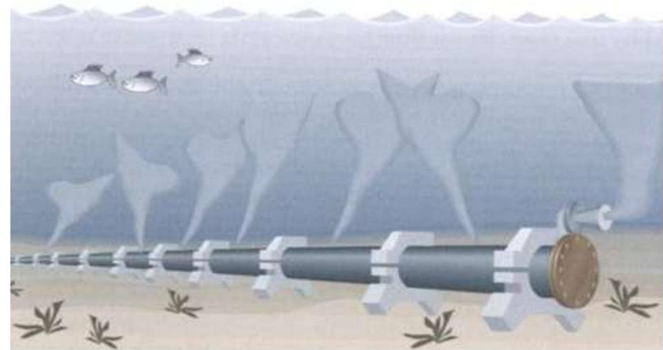
Difusores al final de la tubería de un emisario submarino
