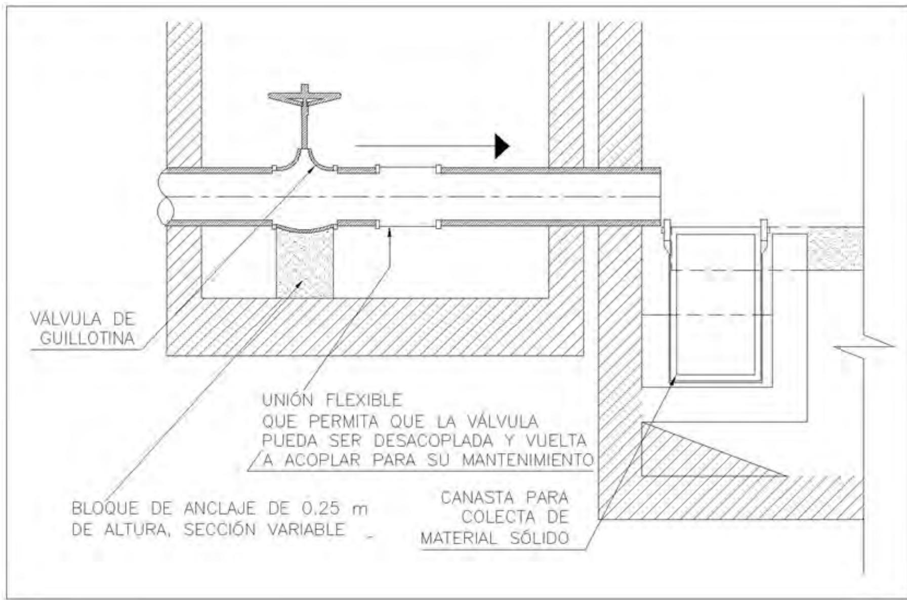
Figura 11.5 Ubicación de Canasta y Losa de Soporte
