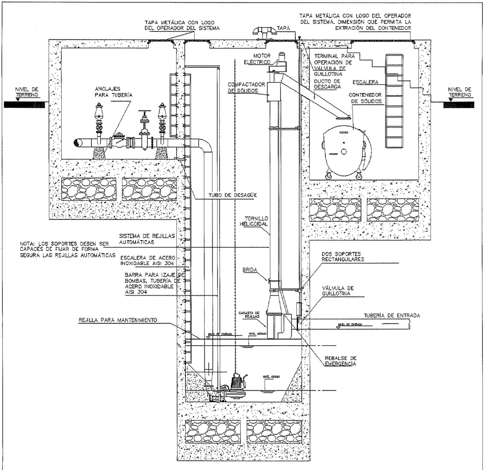
Figura 11.6 Estación de Bombeo con Rejilla Automática
