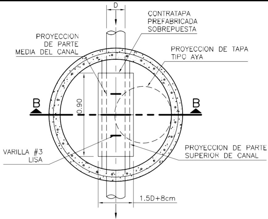
D= DIAMETRO DE TUBERIA DE SALIDA
