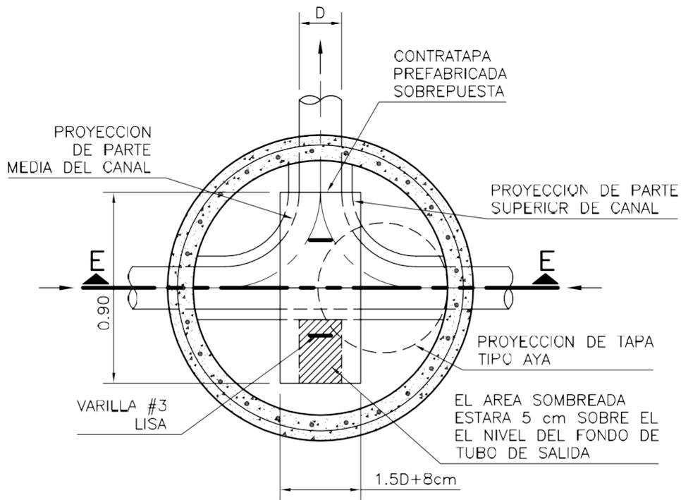
PLANTA  $D = \text{DIAMETRO DE TUBERIA DE SALIDA}$
