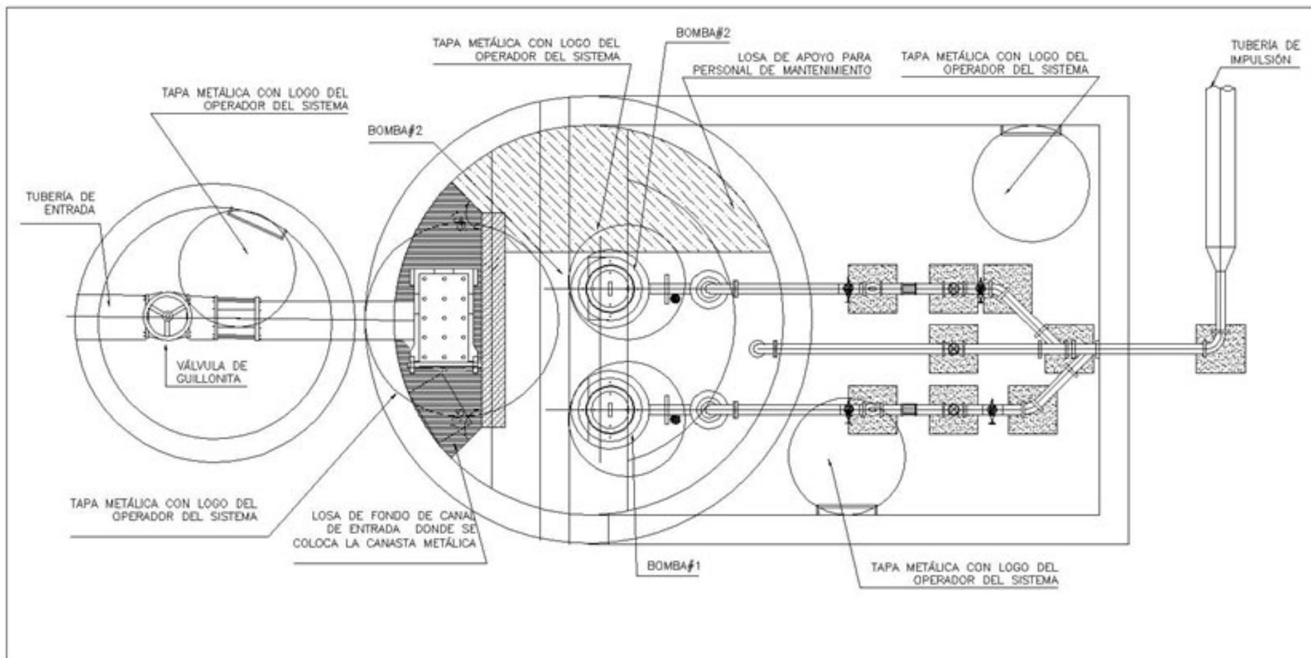
Figura 11.1 Planta de distribución Estación de Bombeo
