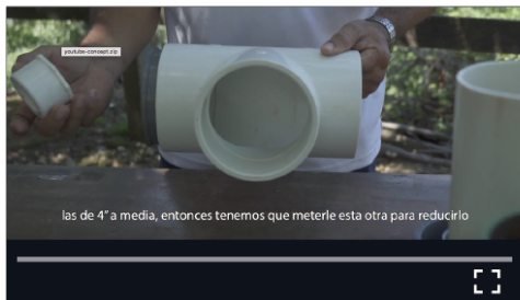
Construcción cloradores artesanales
